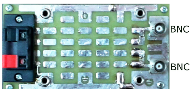
Rys. 1. Widok płytki drukowanej do łączenia obwodów zmiennoprądowych. Do podłączania generatora i oscyloskopu należy używać przewodów BNC.
