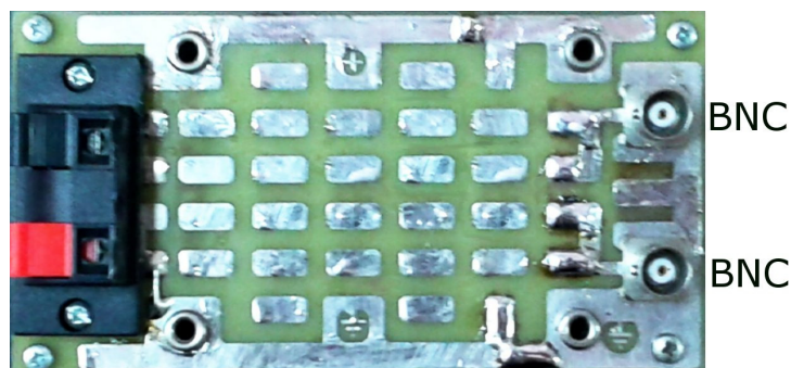
Rys. 3. Widok płytki drukowanej do łączenia obwodów zmiennoprądowych. Do podłączania generatora i oscyloskopu należy używać przewodów BNC.
