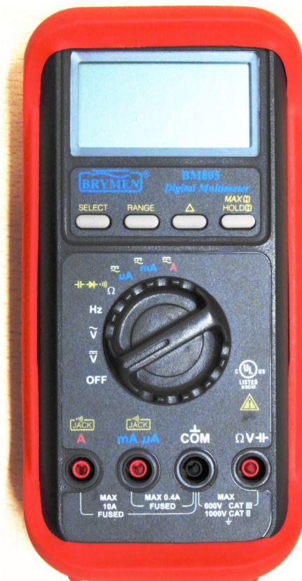
Rys. 1. Przenośny miernik służy m.in. do pomiaru napięcia stałego lub zmiennego, natężenia prądu stałego lub zmiennego oraz oporu elektrycznego. Cztery gniazdka u dołu służą do podłączania miernika do obwodu pomiarowego. Do pomiaru napięcia i oporu wykorzystuje się gniazdka COM (wspólne) i \Omega V , do pomiaru natężenia prądu rzędu miliamperów - gniazdka COM i mA, a dla dużych prądów - gniazdka COM oraz A.
