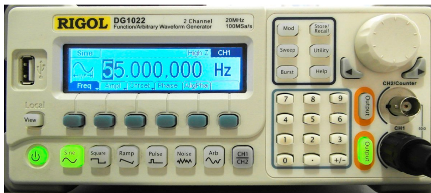
Rys. 2. Generator funkcyjny używany na pracowni, pracujący do 20 MHz.
