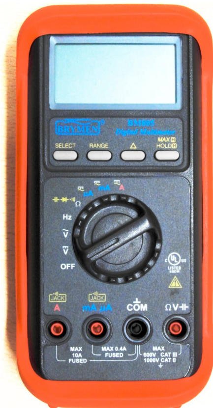
Rys. 1. Przenośny miernik służy m.in. do pomiaru napięcia stałego lub zmiennego, natężenia prądu stałego lub zmiennego oraz oporu elektrycznego. Cztery gniazdką u dołu służą do podłączania miernika do obwodu pomiarowego. Do pomiaru napięcia i oporu wykorzystuje się gniazdką COM (wspólne) i \Omega V , do pomiaru natężenia prądu rzędu miliamperów - gniazdką COM i mA, a dla dużych prądów - gniazdką COM oraz A.
