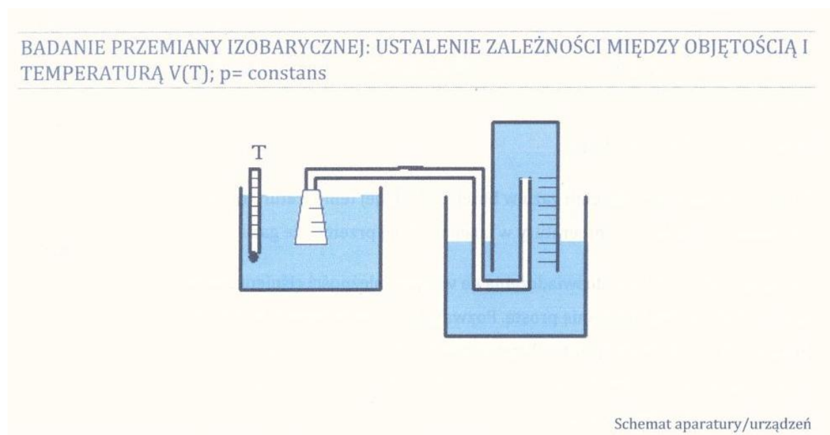
rys .2 Schemat aparatury do badania przemiany izobarycznej gazu
