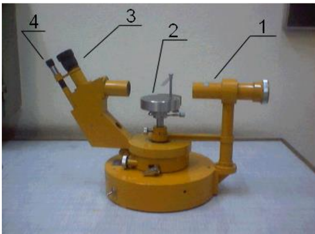
Rysunek 3. Prosty spektrometr pryzmatyczny.
